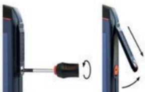
» Lossa skruven från 13-pin ISM-gränssnittets kåpa med skravmejseln som medföljer i det godkända tillbehörspaketet. Ta bort kåpan enligt bilden.
