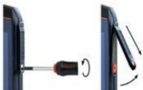
» Povolte šroub na krytu rozhraní 13-pin ISM pomocí šroubováku, který je součástí schváleného balení příslušenství. Podle obrázku odstraňte kryt.
