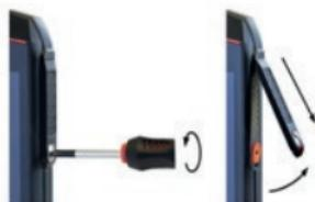
» 承認されたアクセサリパッケージに入っているドライバーで、13-pin ISMインターフェースカバーのネジを緩めます。図のようにカバーを取り外します。
