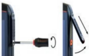
» Ослабьте винт на крышке интерфейса 13-pin ISM с помощью входящей в комплект отвертки. Снимите крышку, как показано на рисунке.
