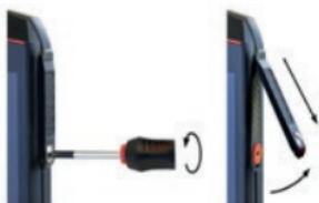
» Uvoľnite skrutku na kryte rozhrania 13-pin ISM pomocou skrutkovača, ktorý je súčasťou schváleného balenia príslušenstva. Odstráňte kryt, ako je znázornené na obrázku.
