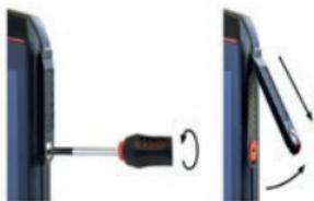
» 使用经批准的附件包装中的螺丝刀拧开 13-pin ISM 接口盖上的螺丝。如图所示拆下盖子。
